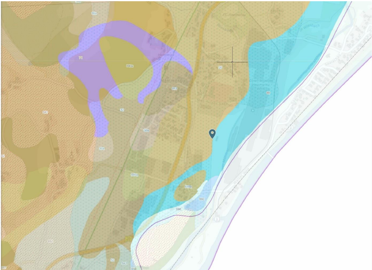
Abbildung 9: Überlagerung des Bodenkunde- und Geodatenatlas des LfU. Demnach liegt das Maßnahmenareal „Hammerau B“ in einer Übergangszone zwischen postglazial abgelagerten carbonatreichen Flussschottern und sandig-kiesigen Aueablagerungen, die wiederum von carbonathaltigen Hochflut- und Verwitterungslehmen (Braunerden) und Auensedimenten überlagert werden. Diese Böden sind insgesamt ein Resultat des ehemaligen Einzugsbereiches des Salzach-Saalach-Gletschers, bei dessen Rückzug bzw. dem Abschmelzen der Gletscher im Frühholozän wiederum die beiden gleichnamigen Flußtäler entstanden, die mit ihren ursprünglich weit verzweigten Flussarmen die Landschaft nachhaltig prägten. ©Bayerisches Landesamt für Umwelt
