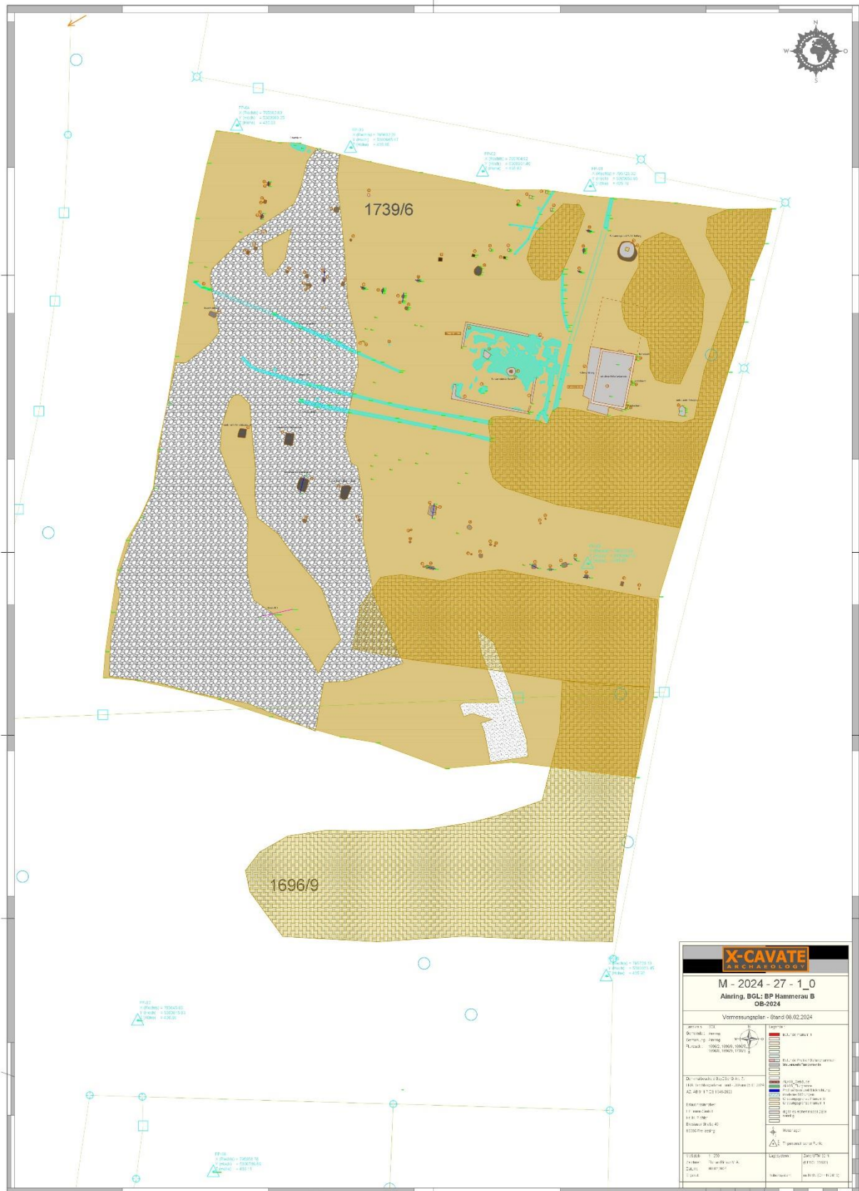
Abbildung 2: Aktuelle CAD-Gesamtplanansicht der bisher vermessenen Befunde, Störungen, topographischen Merkmale und Haufwerke, geplottet in DinA1, Maßstab 1:250. Der CAD-Plan wird soweit möglich tagesaktuell gehalten und stetig um die neu abgezogenen Flächenteile samt allen darin enthaltenen Strukturen erweitert. ©X-Cavate Archaeology
