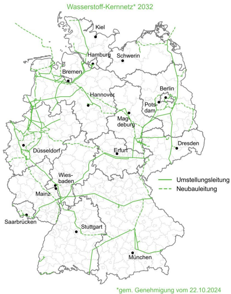
Abbildung 17: Genehmigte Planung für Wasserstoff-Kernnetz [Quelle: FNB Gas 2024]
